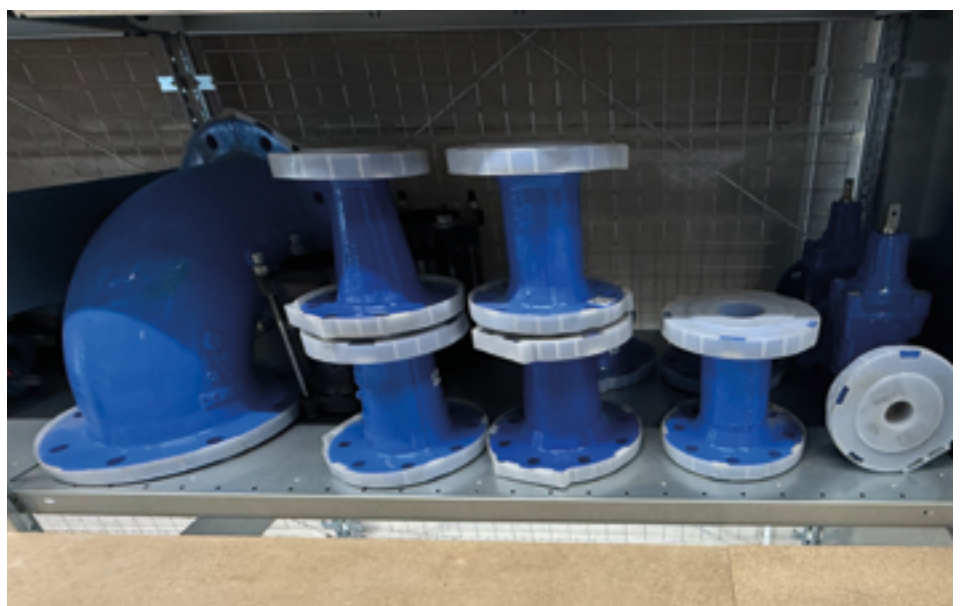
Saubere Lagerung von Armaturen und Formstücken für Trinkwasserleitungen – mit Schutzkappen gegen Staub und Verunreinigungen.
