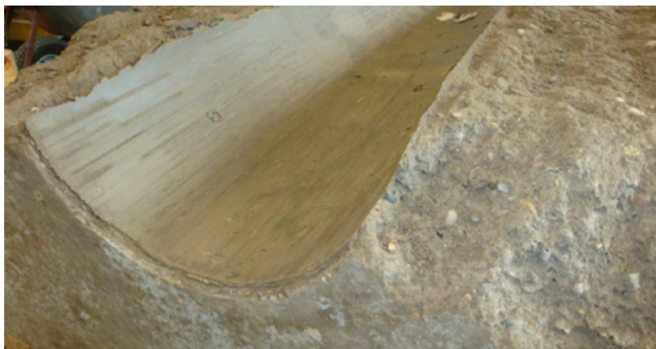
Wandeffekt bei der Rohrbettung mit ZFSV nach Freilegung des eingebetteten Rohres (Quelle: OTH Regensburg/Labor für Geotechnik)
