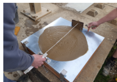
Qualitätssicherung Ausbreitmaß ZFSV (Quelle: AGFW)
