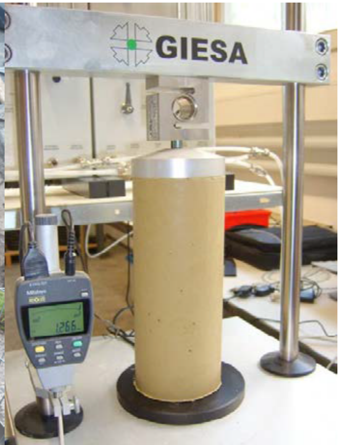
Einaxiale Druckfestigkeitsprüfung an einem ZFSV-Prüfkörper
